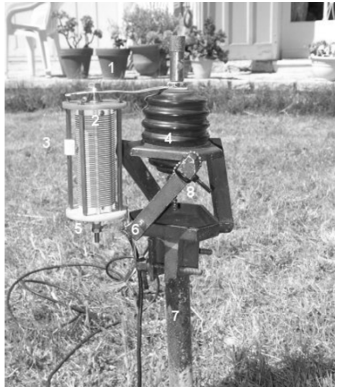
L'embase est fixée sur un tuyau métallique fiché en terre (ici environ 50 cm en terre et 30 cm dehors)
