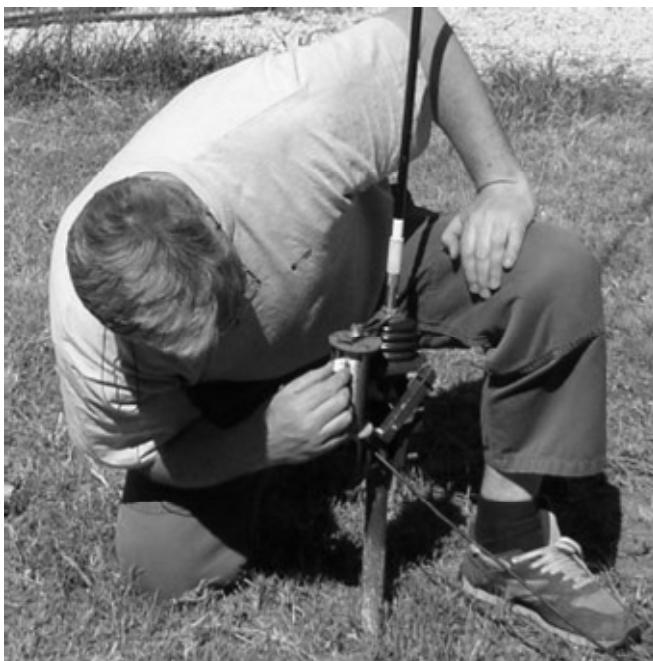
Réglage du curseur. Les spires sont marquées au feutre sur les différentes résonances !
